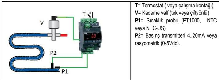
**4.7 BESLEME BAĞLANTISI****Şebeke Beslemesi:** XEV22D 24Vac/dc ile çalışmaktadır.
